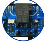
PCB üzerinde şeffaf silikon ile su geçirmezlik işlemi
